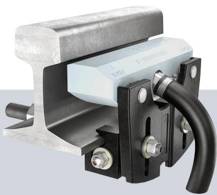
En este proyecto se utilizan las garras del carril SK150 y SK420 de Frauscher, para asegurar el montaje simple y fácil del sensor de rueda en la vía sin necesidad de perforación. La garras del carril SK420 se utiliza en la vía principal y la SK150 en la vía del depósito de trenes. La SK420 también se puede instalar en carriles acanalados, y la SK150 incorpora pinzas a ambos lados para facilitar al máximo el ajuste de la garras a diferentes tamaños de pie de carril.
